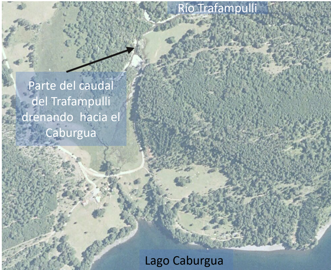
Figura 17. Parte de fotografía aérea del SAF del año 2007, se muestra el cauce aportando parte del caudal del río Trafampulli hacia el Caburgua. Fotografía aportada por Caburgua Sustentable.
