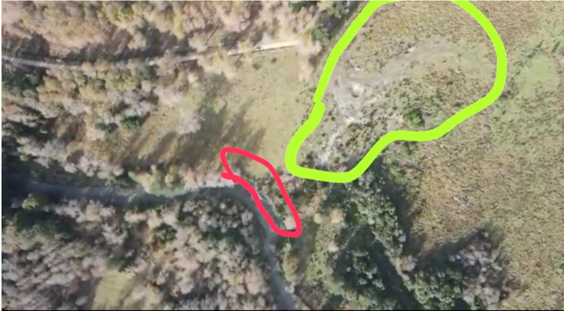
Dique artificial oficiado a ser construido por la Dirección General de Aguas de Chile, cortando el brazo del Rio Trafampulli que fluía al lago Caburgua. En rojo el actual dique, y en amarillo el curso seco del brazo del rio que se secó. Vuelo dron 2021.
